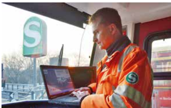
Kallms liest während der Fahrt den Speicher des Zuges aus, um anhand der Fehlermeldung zu entscheiden, wie weiter vorgegangen wird.
