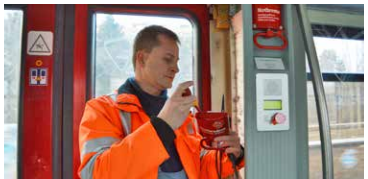
Die Standzeit des Zuges wird genutzt, um schnelle Abhilfe bei Problemen zu schaffen, zum Beispiel beim Austausch einer defekten Notbremse.
