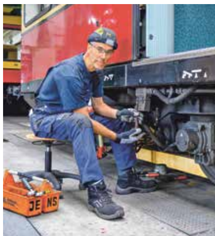
Norbert Möhr klemmt das Drehgestell ab
