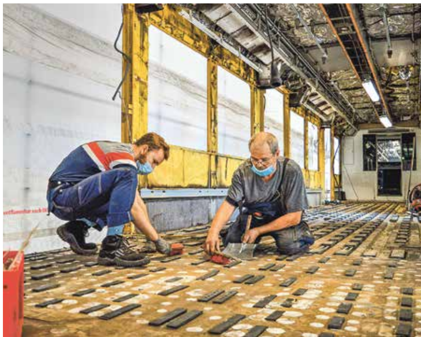
Paul Weese und Uwe Heinze beim Abschluss der Fußboden-Demontage, bevor der Wagenkasten an die nächste Bearbeitungsstation übergeben wird.
