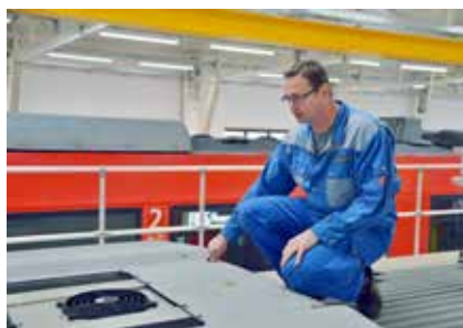
Mitarbeiter Christian Frambach inspiziert auf dem Dach die Klimaanlage eines Triebwagens.
