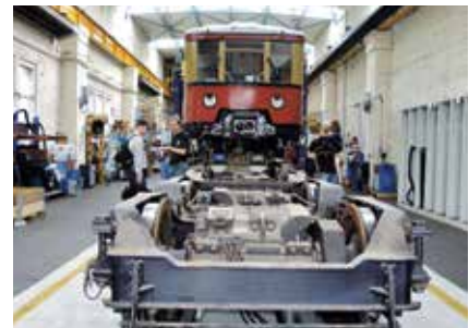
In der Kranhalle gab die Hubbockanlage den Blick auf Schaltwerk, Fahrmotor und Druckluftleitung der BR 167 frei.
